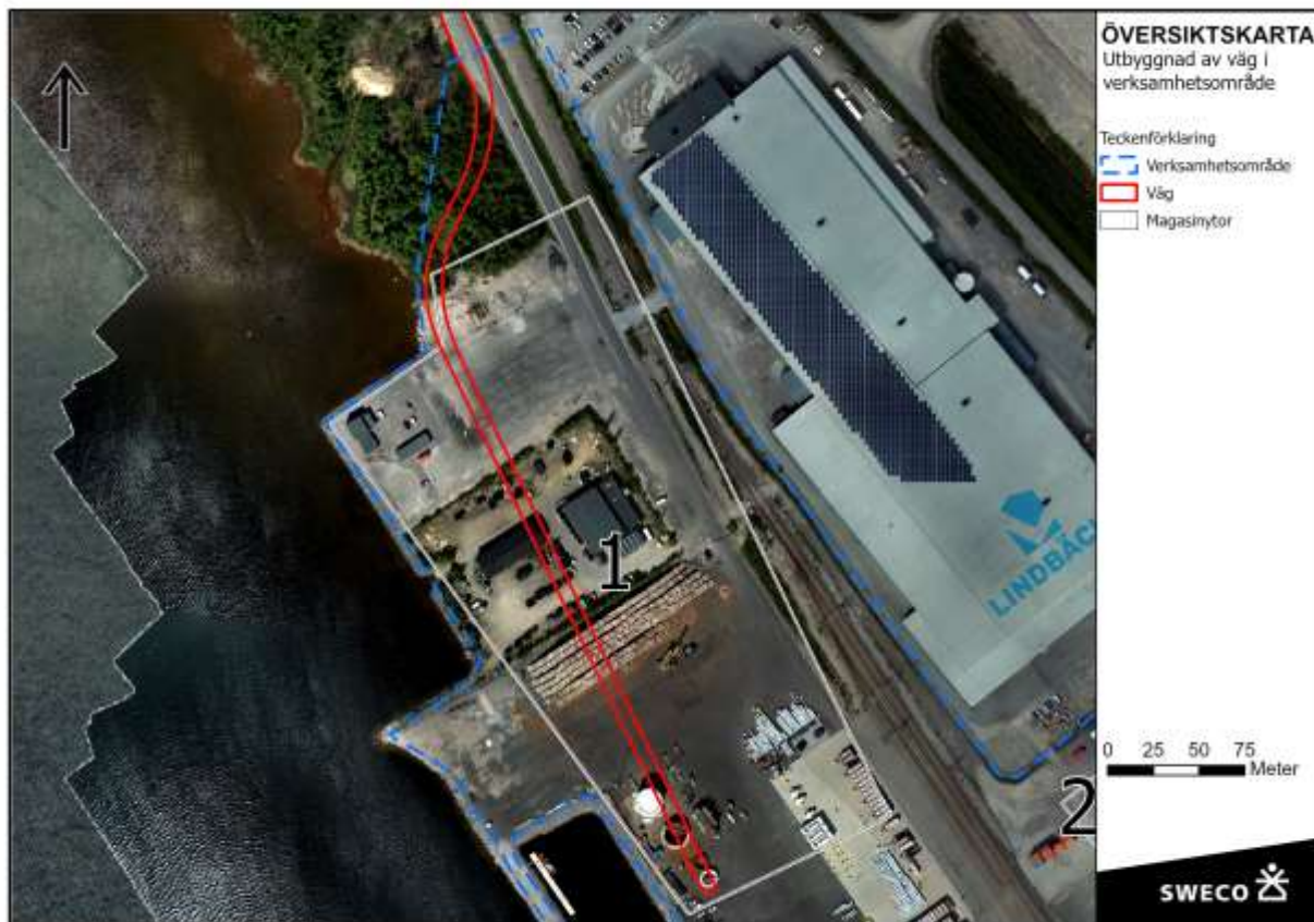
Figur 4-5: Redovisning av yta för tillkommande väg in verksamhetsområdet. I figuren redovisas även H2GS:s planerade lagerutrymme för coils och hur den nya vägen ansluter till denna nya lagerutrymmesyta.
